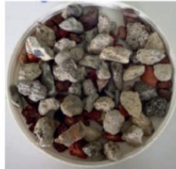
30 % maçonnerie - 70 % béton
