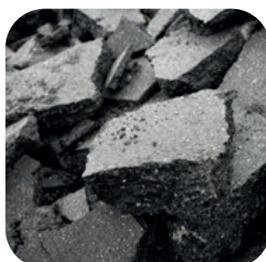
**3** | **Les déchets hydrocarbonés** proviennent essentiellement de la démolition sélective des voiries et de la déconstruction de parkings et autres surfaces asphaltées. En fonction de la technique utilisée on les trouvera sous forme de plaques ou de fraisât. Ce fraisât est obtenu par raclage mécanique des revêtements.
