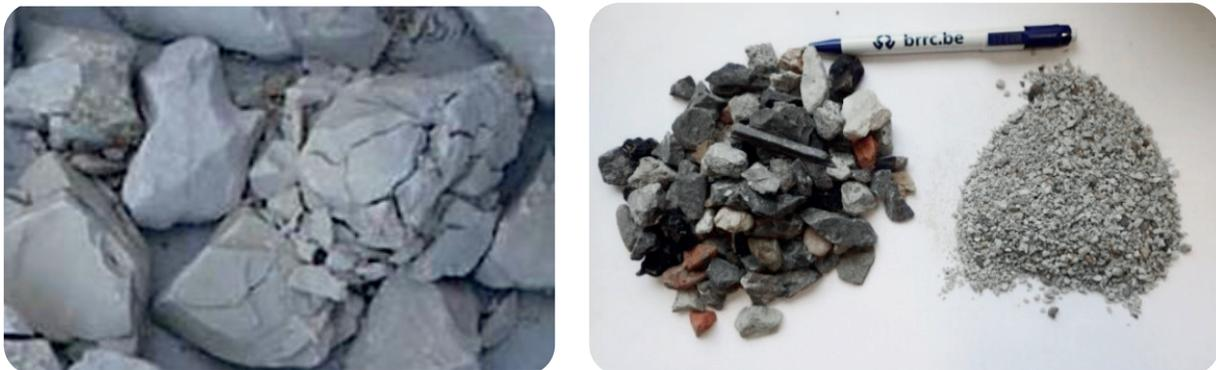
Figure xx : Exemples de roche crayeuse en cours de processus de gélifraction (à gauche) ou de recyclés après l'essai de sensibilité au gel (à droite) (Source : Internet et JB Conseils).
