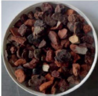
100 % maçonnerie - 0 % béton
