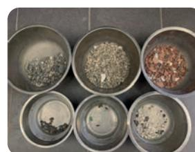
L'analyse permet également de déterminer les contaminants flottants (FL) et non-flottants (X) dans les granulats recyclés.
