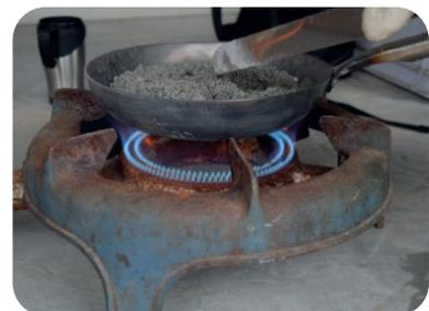
Exemples de méthodes de détermination de la teneur en eau. De gauche à droite, étuve, four à micro-ondes et poêle sur flamme (Sources : CRR, internet et JB Conseils).
