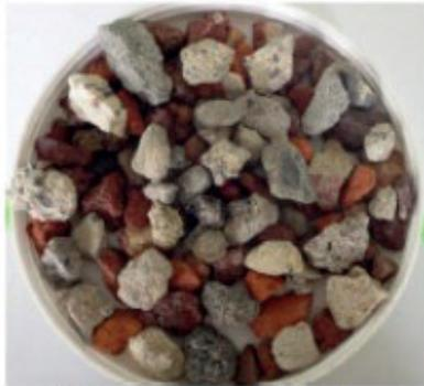
50 % maçonnerie - 50 % béton
