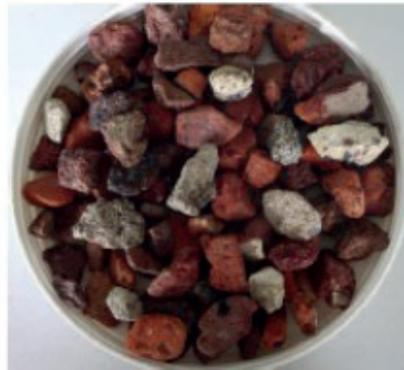
90 % maçonnerie - 10 % béton
