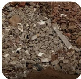
**2** | **Les déchets mixtes** proviennent de la déconstruction/rénovation de bâtiments publics ou privés (briques/blocs/tuiles ...). Ces déchets représentent en tonnage la fraction la plus importante produite en Wallonie. Ils sont typiquement constitués d'un mélange de différents déchets de construction (briques, blocs en béton, tuiles, faïences, céramiques, etc.). Ces déchets sont caractéristiques des collectes sélectives réalisées auprès des particuliers/grand public.
