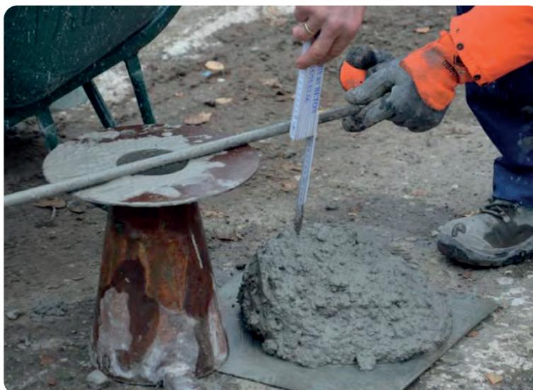
Mesure de la consistance du béton à base de granulats recyclés (monographie CSTC-CRR)
