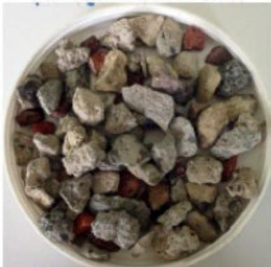
10 % maçonnerie - 90 % béton
