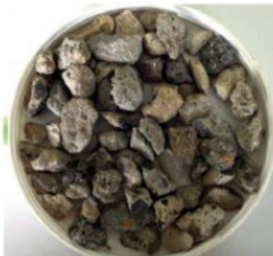
0 % maçonnerie - 100 % béton
