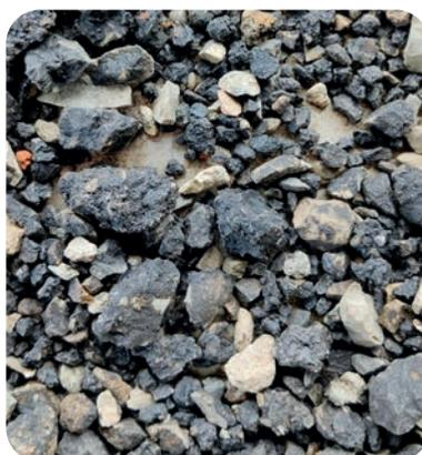
Un granulats recyclé d'hydrocarboné est défini en fonction de sa composition (pourcentage des différents constituants). Les trois catégories reprises dans le tableau ci-dessous sont généralement utilisées mais le Qualiroutes ne préconise la mise en œuvre que de granulats recyclés d'enrobés hydrocarbonés (les mélanges de sortes de granulats ne sont pas explicitement détaillés).
