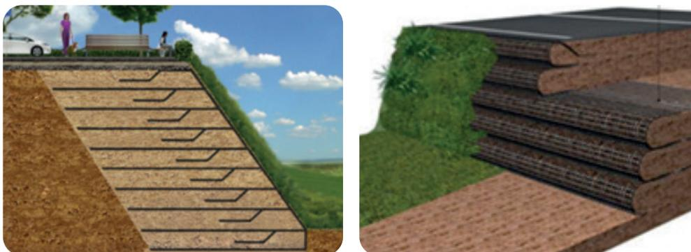
Principes de construction d'un remblai renforcé : succession de couches de matériau de remplissage compacté et de renforcements (dans le cas présent : des géogrilles) – source : HUESKER
