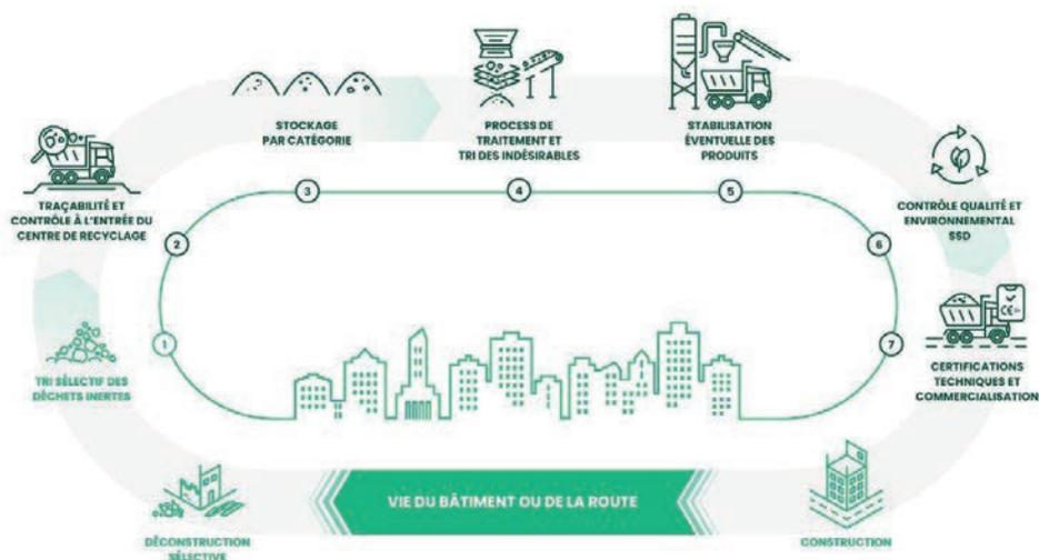
Parcours du déchet de construction au granulat recyclé
