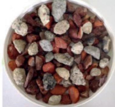
70 % maçonnerie - 30 % béton
