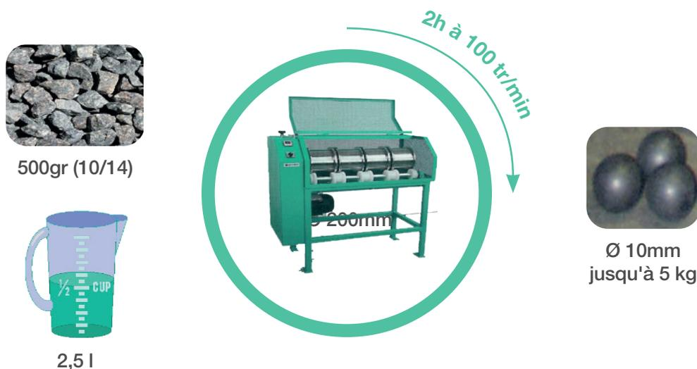
Dispositif de l'essai Micro-Deval en présence d'eau (Source : CRR).
