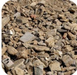
**1** | **Les déchets de béton** proviennent de la démolition de bâtiments ou d'infrastructures de génie civil (bétons ou bétons armés). Le béton est un mélange inerte de sable, gravillon, d'eau et de ciment.
