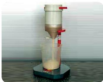
Appareil de mesure du coefficient d'écoulement des sables (Source : Internet).
