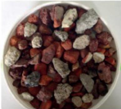
80 % maçonnerie - 20 % béton
